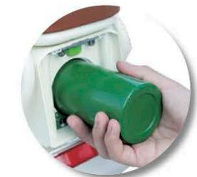
ポータブル固体水素カートリッジは、水素貯蔵タンク、水素吸収合金粉末、開閉弁で構成されており、水素はこの合金粉末に吸着されます。このカートリッジは、製品の体積の500倍以上の水素を貯蔵でき、内部の圧力は約1MPaです。
